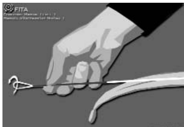
En vrillant la corde nous rendons ses brins plus homogènes.
