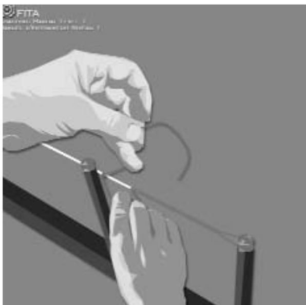
Enrouler le fil renfort à contresens sous le pont.
